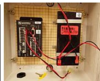
内部は、C-CR300通信装置と鉛電池のみとシンプルな構造
