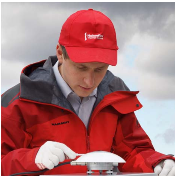
長波放射計設置状況
